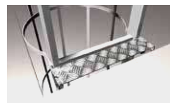
GRADINO DI USCITA IN LAMIERA MANDORLATA DI ALLUMINIO MM 150 Output step in aluminium sheet 150 mm CODE 20970
